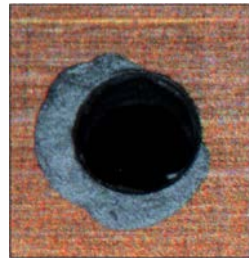
Bild 16: Lochauskleidung mit Silberleitlack bei einer im beschriebenen Verfahren erzeugten Durchkontaktierung
