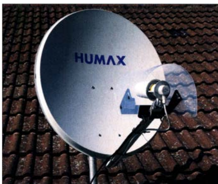
Bild 6: Sende-Empfangs-Antenne mit selbst gebautem Duoband-Erreger als Kombination aus Helix-Antenne und modifiziertem LNB [7]
