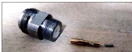
Bild 3: Ausgebaute N-Buchse mit losgelöstem Mittelleiter, in dessen rechtes Ende die kleine Spiralfeder gehört. Die umlaufend aufgeraute Oberfläche sollte für seinen festen Sitz in der weißen PTFE-Scheibe sorgen, was hier jedoch nicht geschah.
