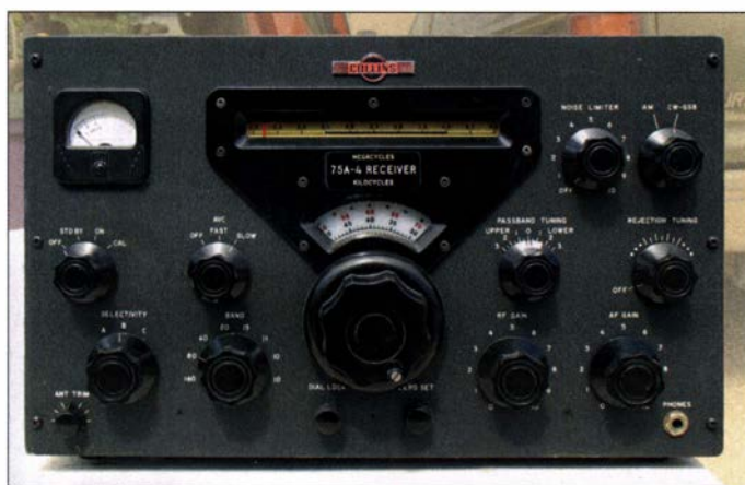
Bild 5: Der Collins 75A-4 war mit dem eingebauten Produkt-detektor bereits gut für den SSB-Funkbetrieb gerüstet.
