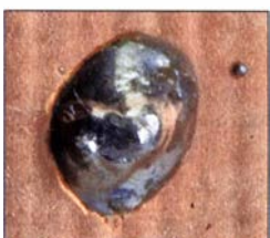
Bild 7: Nahaufnahme einer Durchkontaktierung mit massivem, 0,6 mm dicken Draht
