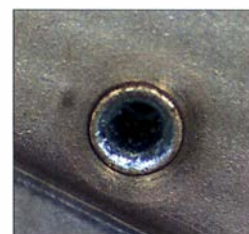
Bild 14: Nahaufnahme eines korrekt gesetzten Durchkontaktierungskabels
