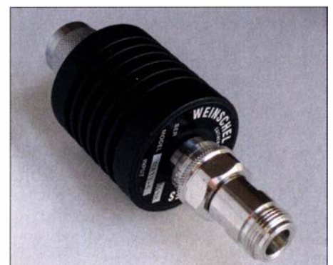
Bild 1: Repariertes Leistungsabschwächer Weinschel WA33-6 mit angeschraubtem Adapter zur Entlastung der Buchse
