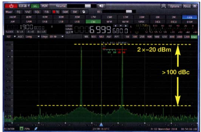
Bild 4: Intermodulationsfreier Anzeigebereich in Abhängigkeit vom Mischereingangsspiegel und der Auflösungsbandbreite (blaue Linien, Rauschpegel), hier grün eingezeichnet für RBW = 1 Hz; rote Linie: Intermodulationsprodukte 3. Ordnung
