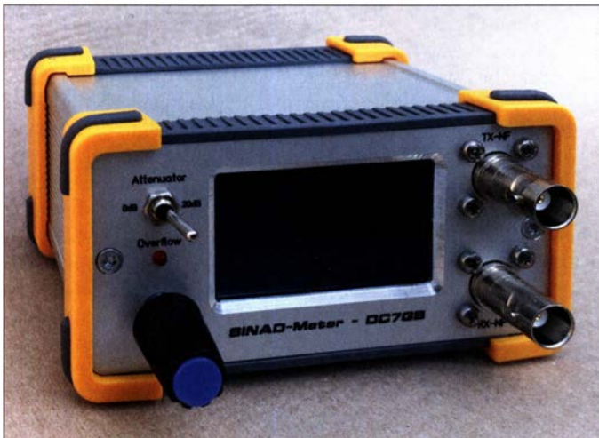
Bild 1: Ansicht des SINAD-Messgeräts Foto, Screenshot: DC7GB
