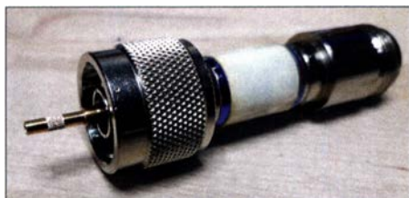
Bild 2: Der Mittelleiter aus der N-Buchse des Dämpfungsglieds steckt nach dem Lösen der Verbindung noch auf dem Steckkontakt des zweiten Abschwächers.
