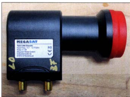
Bild 1: Modifizierter handelsüblicher Twin-LNB; einer der beiden Anschlüsse dient nun als Eingang für das GPS-stabilisierte Oszillatorsignal [1]. Foto: DH8AG
