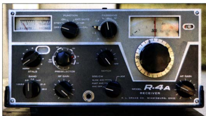
Bild 7: Der Empfänger Drake R-4A kam 1965 auf den Markt und setzte neue technische Akzente.
