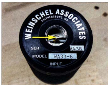
Bild 4: Der Anschlusskontakt für den N-Buchsen-Mittelleiter an der Stirnseite der Platine wird nach dem Ausbau der N-Buchse sichtbar. Fotos: DH8AG
