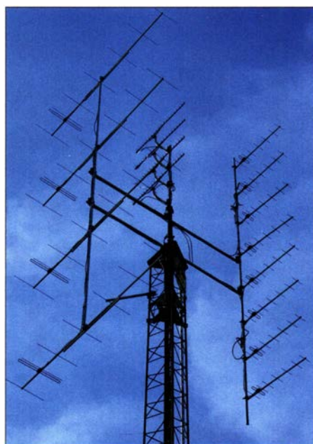
Die Antennengruppen für 2 m, 70 cm und 23 cm: Durch die vertikale Stockung deckte SK7MW stets einen großen Winkelbereich bei hohem Gewinn ab. Foto: SM7EYV
